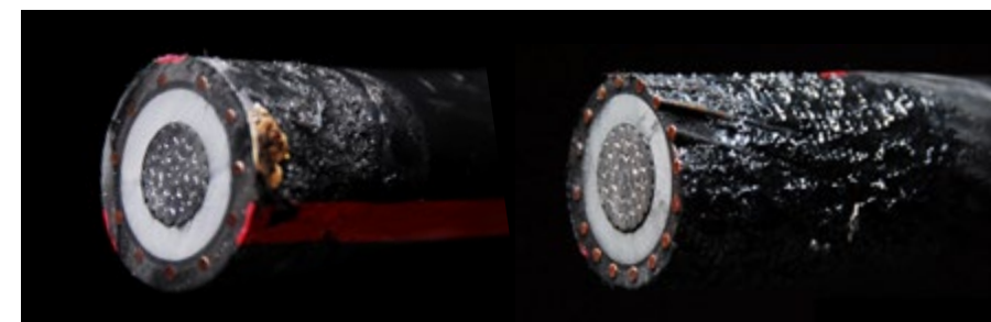
Cable protegido con Scotch® 77 después de la prueba
